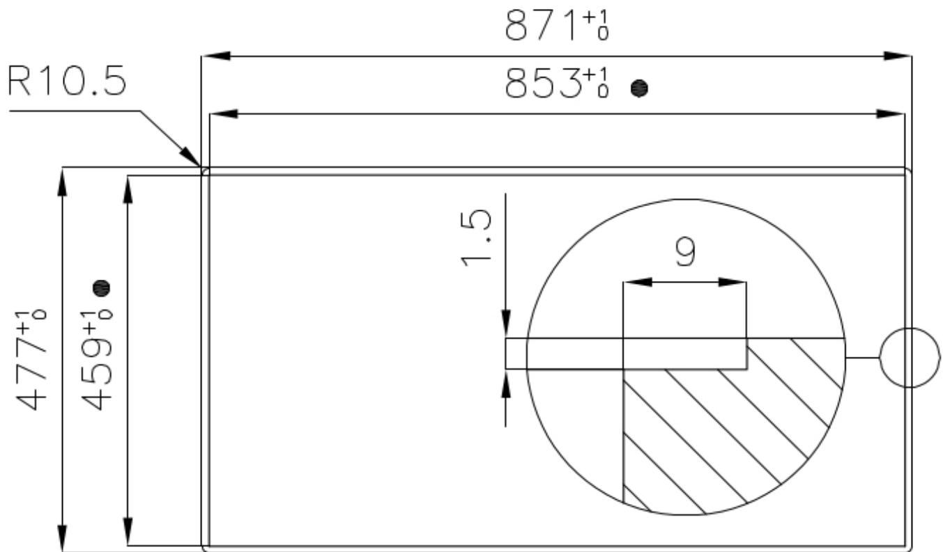
● Built-in cut out for FTS – Foratura per installazione FTS
